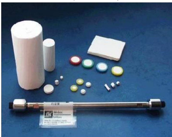
Obr.5 Porovnání tvarů a velikostí monolitů od firmy BIA Separations s běžnou částicovou kolonou (150 x 4.6 mm ID)
