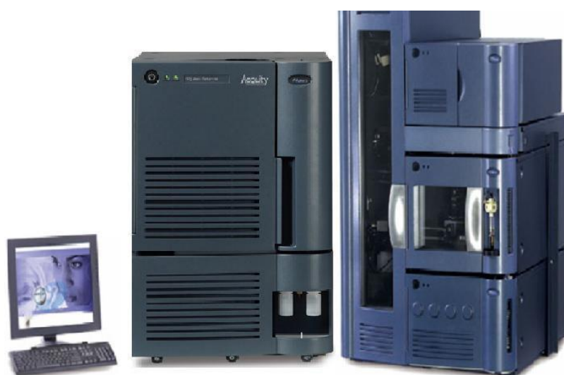
Obr. 4: UHPLC analytický systém doplněný o MS/MS typ detekce [9].
