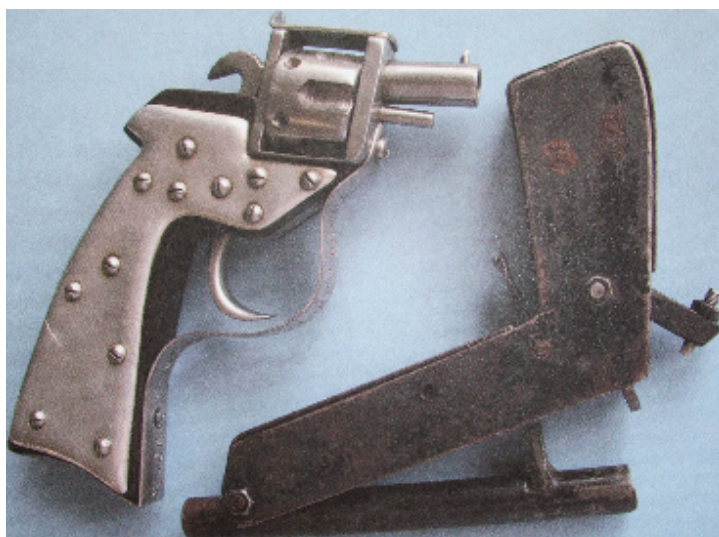
obrázek 2 – zbraně vyrobené podomácku (PLANKA, B. a kol. Kriminalistická balistika . s. 634)
