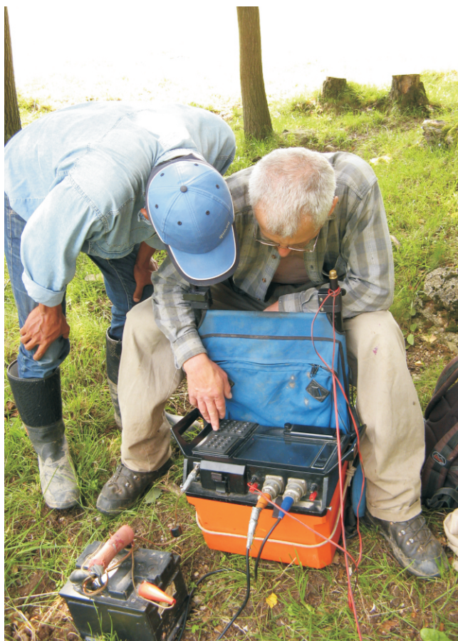
Měření mělkou refrakční seismikou, Andělské sedlo
