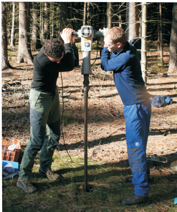
Ruční vrtání a odběr vzorků v Andělském sedle.
