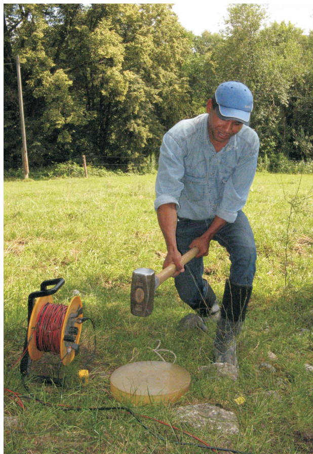
Měření mělkou refrakční seismikou, Andělské sedlo
