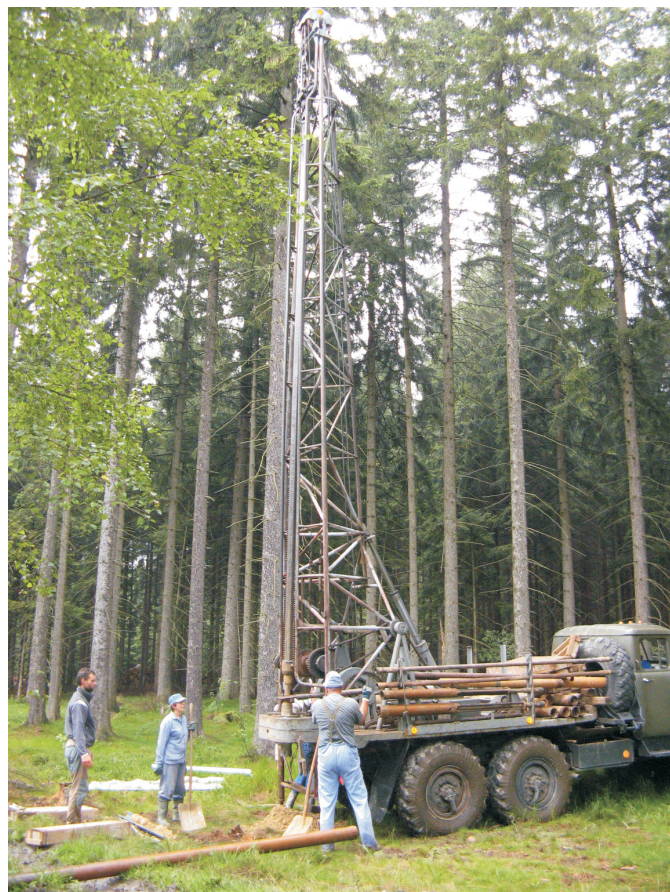
Strojové vrtání v Andělském sedle. Vrt S, 16 m.
