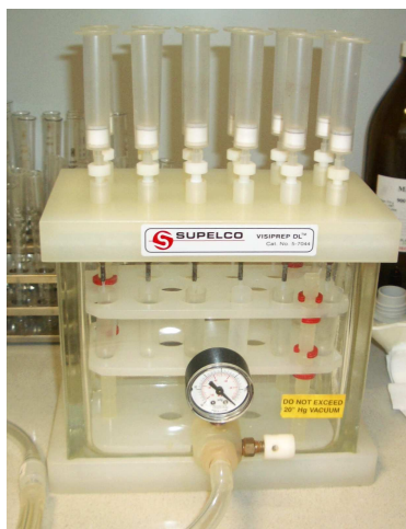
Obr. 21 Manuální extraktor Visiprep™ SPE Vacuum Manifold DL využitý při úpravě biologických vzorků před vlastní HPLC analýzou.
