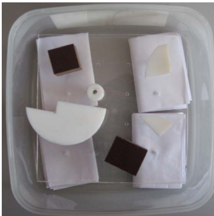
Forma pro agarový fantom s vloženými nehomogenitami.
