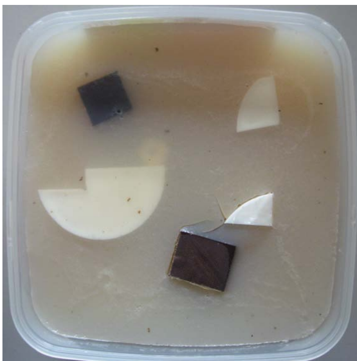
Forma pro agarový fantom s vloženými nehomogenitami a vytvrzeným agarem
