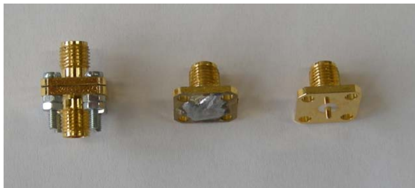
Obr.6.5. Kalibrační sada pro SMA konektor: OPEN, SHORT, SMA konektor.
