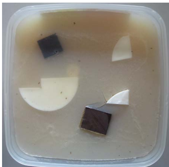
Obr.7.2. Forma pro agarový fantom s vloženými nehomogenitami a vytvrzeným agarem.
