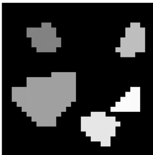
Obr.8.5. Výsledek měření agarového fantomu při f = 1000 \text{ MHz} zobrazený pomocí jasové modulace v 8 bitech šedi.
