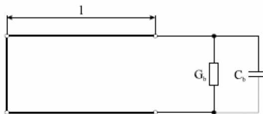
Obr.5.1. Náhradní obvod sondy.
