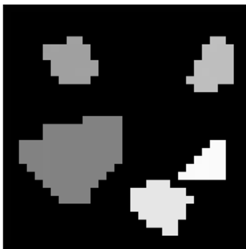
Obr.8.3. Výsledek měření agarového fantomu při f = 500 \text{ MHz} zobrazený pomocí jasové modulace v 8 bitech šedi.
