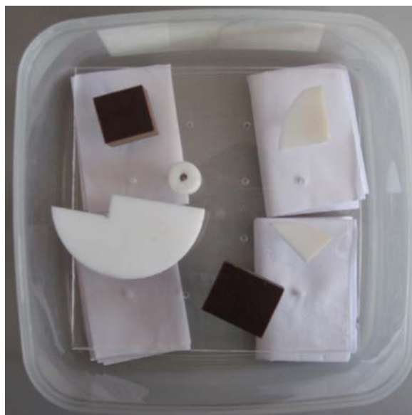
Obr.7.1. Forma pro agarový fantom s vloženými nehomogenitami.
