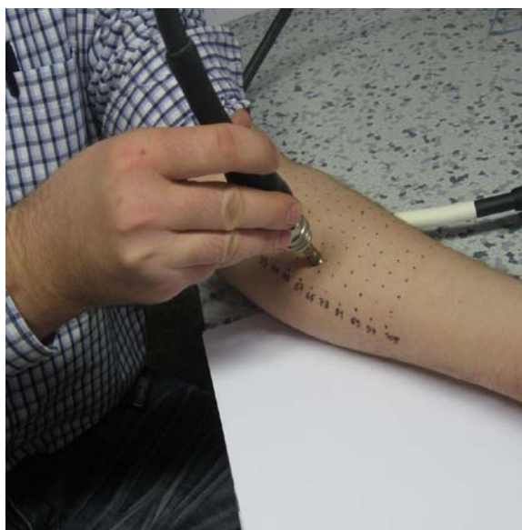
Obr.7.6. SMA sonda při měření biologické tkáně „in vivo“.
