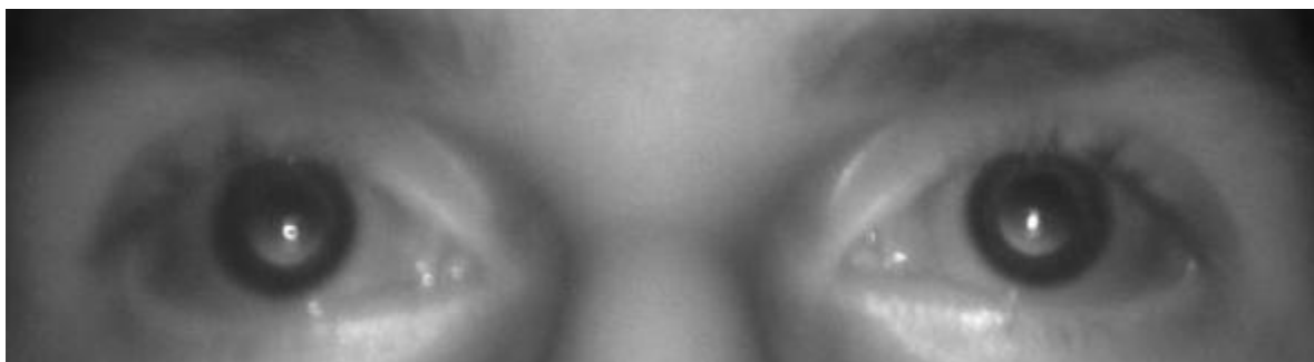
Obrázek 3.2: Pořízený odraz IR záření od sítnice při experimentálním ověřování kamery.
