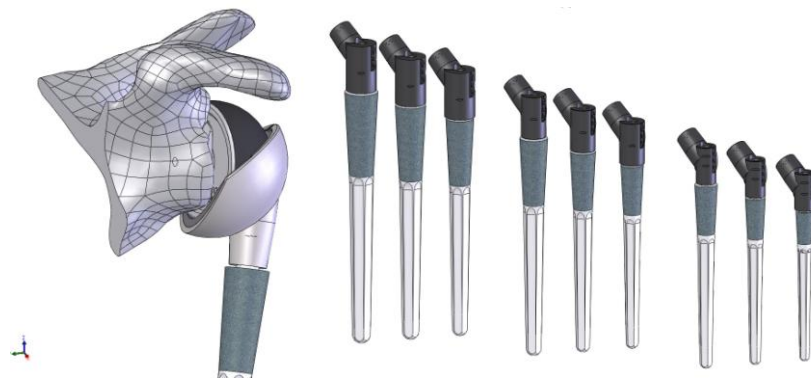
Obr.64 Design nové generace dříků náhrady ProSpon (poskytl ProSpon, Ing. Zdeněk Čejka)
