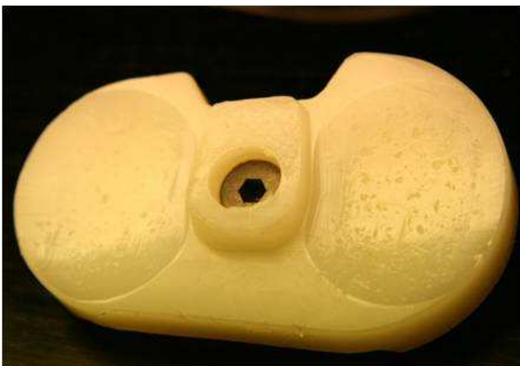
Obr. 2. Extrahované tibiální komponenty – zřejmě jsou podélné rýhy a tzv pitting, vznikající podpovrchovou delaminací
