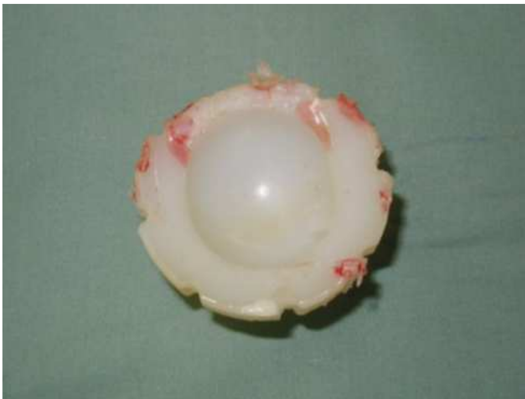
Obr.1. Deformace acetabulární polyetylenové komponenty. Decentrace středu artikulační komponenty jako následek úbytku polyetylenu v zátěžové zóně
