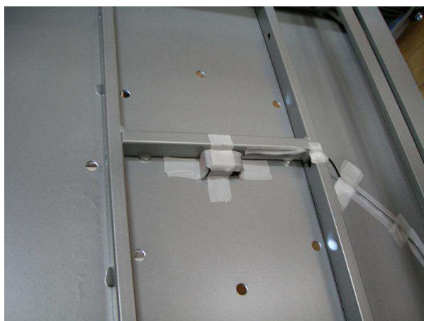
Obr.22 b: Senzor – akcelerometr připevněný uprostřed zesoda na diagnostické a terapeutické ploše Posturomed (Rašev, 2009)
