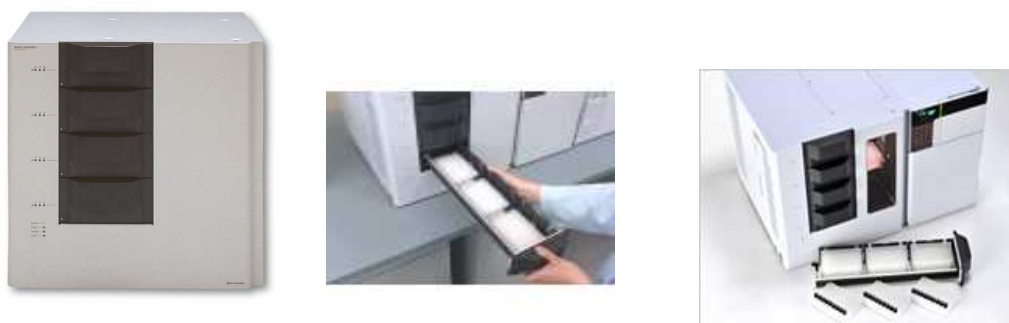
Obr. 22 Ukázka autosamplérů pro mikrotitrační destičky Rack Changer (Shimadzu, Kyoto, Japonsko)
