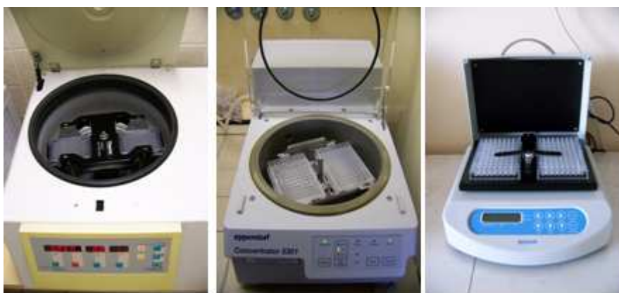
Obr. 79 Rotory na mikrotitrační destičky pro centrifugaci, odpařování a třepání
