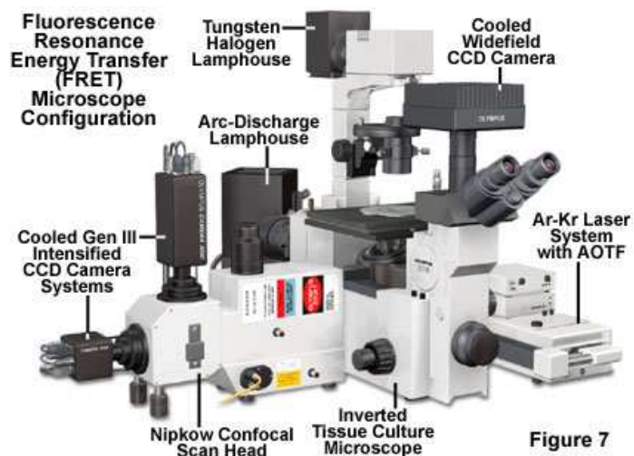
Obr. 68 FRET nanosenzor v spojení s mikroskopem [170]
