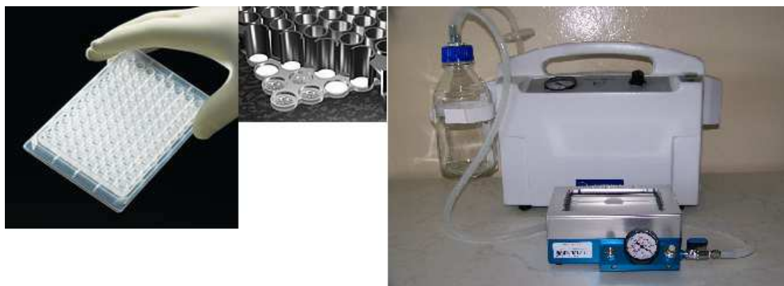
Obr. 88 Zařízení pro filtraci vzorků s využitím mikrotitračních destiček
