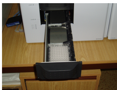
Obr. 81 Rack Changer - autosampler pro mikrotitrační destičky
