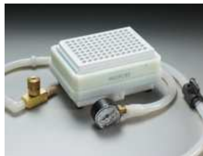
Obr. 42 Vakuový manifold pro SPE mikrotitrační destičky (Fisher Scientific, USA)
