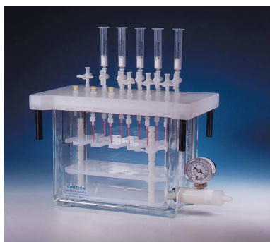
Obr. 41 Vakuový manifold pro SPE kolonky (Teknokroma, Barcelona, Španělsko)
