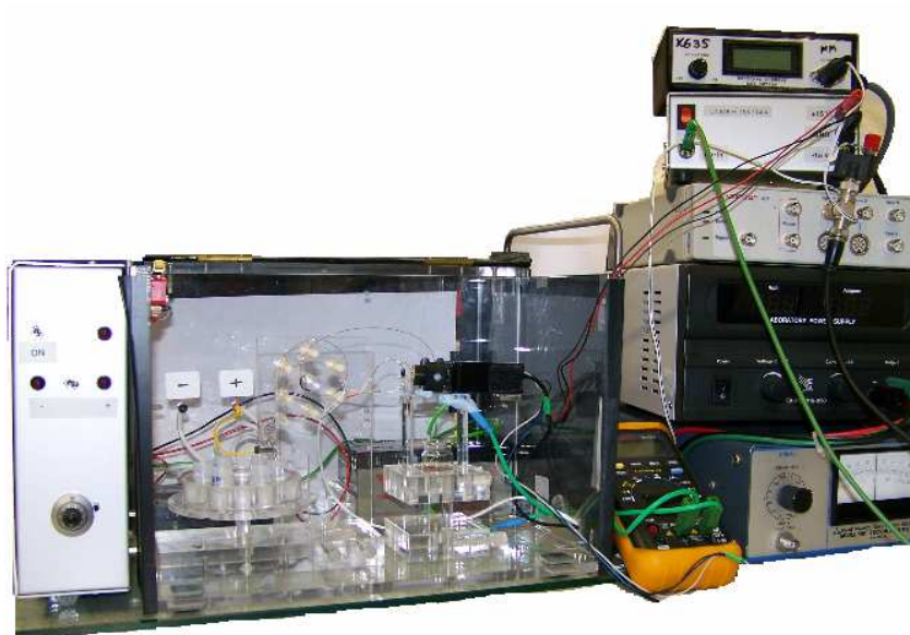
Obr. 98 Kapilární elektroforéza (přístroj sestavený v laboratoři DCU)
