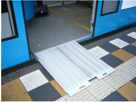
rozkládací plošina ve voze tramvaje
