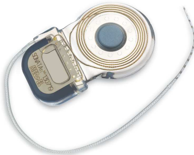
Obrázek 14: Kochleární implantát. Přijímací cívka a sada elektrod kochleárního implantátu SONATA společnosti MED-EL. [Převzato z tiskové zprávy společnosti MED-EL.]
