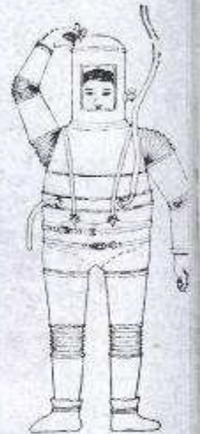
1838 W. H. Taylor navrhl pancéřový skafandr a vyvažovací nádrž v horní části přilby
