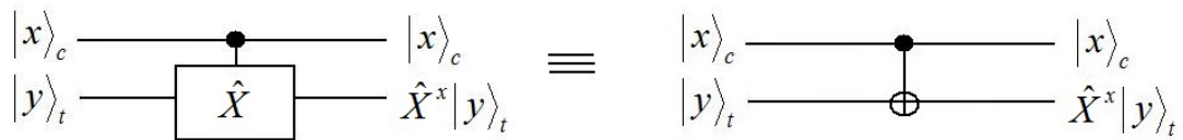
Obr. 7: Dvě různá schématická znázornění 2-qubitového hradla CNOT . Tradičně se používá spíše to vpravo.
