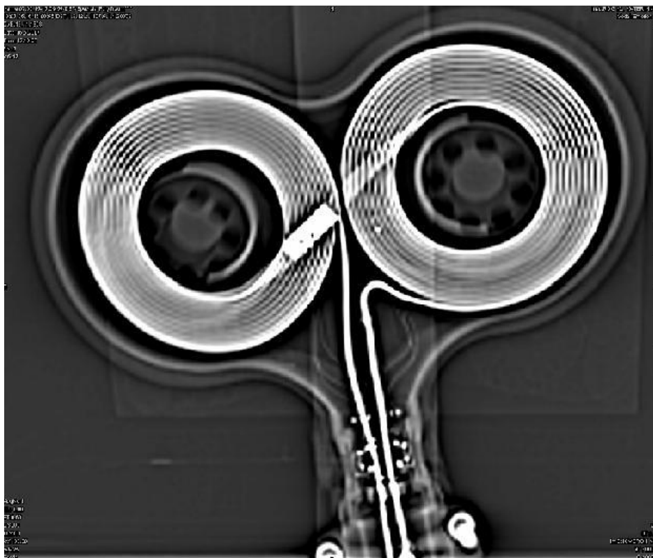
Obrázek č. 8. RTG osmičkové cívký ukazuje způsob navinutí obou cívek.
