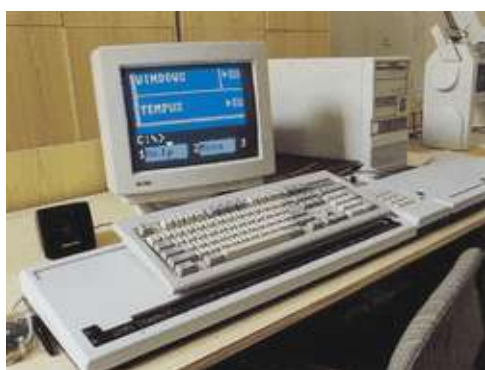
Obrázek 26 Počítač s Braillovým řádkem a hlasovým výstupem
