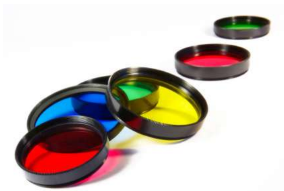
Obrázek 6 Filtry (zvýrazňují kontrast a prokreslují detaily)
