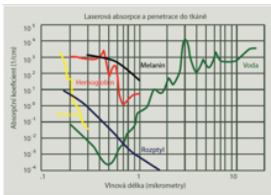
Obr. 4: Koeficienty absorpce cílových chromoforů v závislosti na vlnové délce
