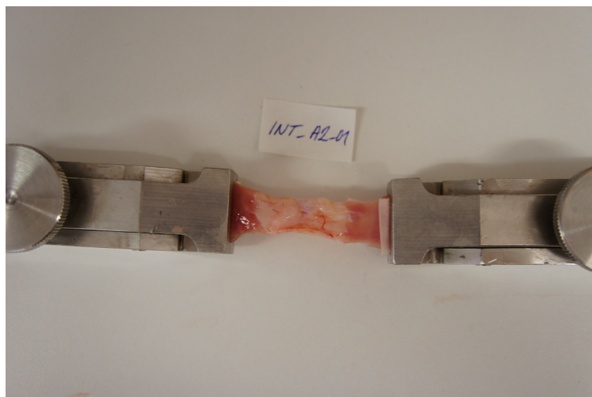
Obr. 13: Uchycení vzorku do čelistí tensiometru
