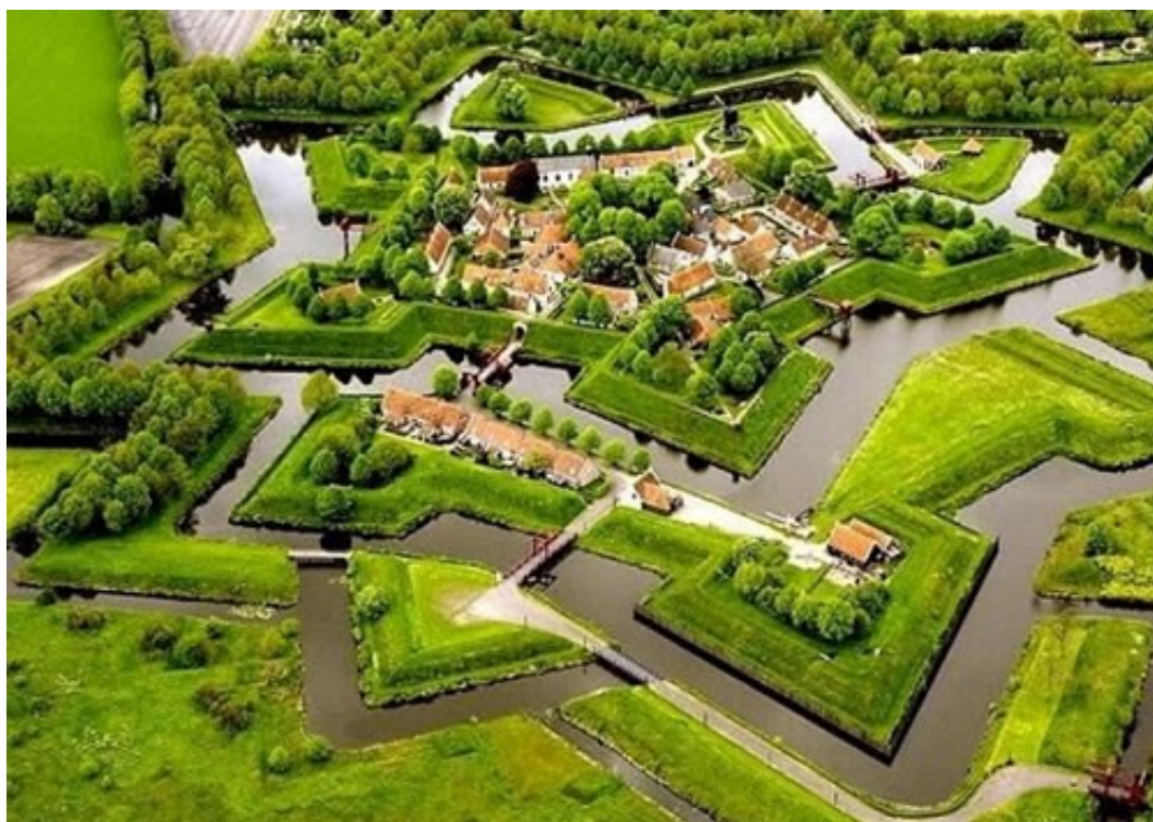
Nahoře: staroholandská pevnost Bourtagne, která se zachovala v čistě zemním provedení. Krigsarkivet: 0406:14:010:002 Bourtagne Platte grond van de forteresse Bourtagne ten 1742 Nauwkeurig opgenomen. Dole : Bourtagne v dnešní zachované podobě. Je naprosto patrné čistě zemní provedení hradeb při zachování bastionového půdorysu. Viditelný je i systém vodních příkopů.
