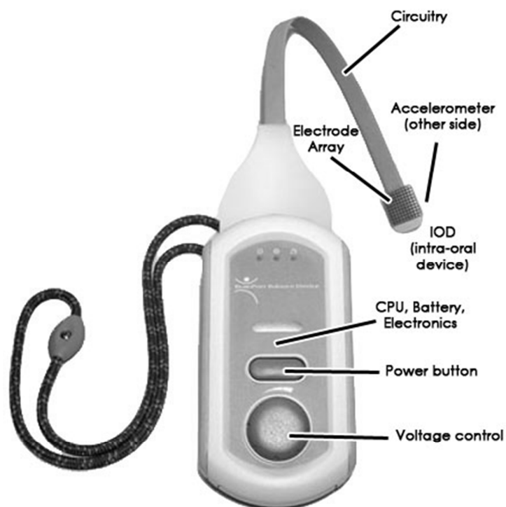
Obr. 2: Přístroj BrainPort ® (Wicab, Inc.) Circuitry = obvody; Electrode Array = elektrodové pole; Accelerometer = akcelerometr; IOD (intra-oral device) = intraorální jednotka; CPU (central processing unit) = řídicí jednotka.
