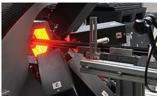
Obrázek č. 2: Kontinuální vulkanizace – vstup do vulkanizačního tunelu (zdroj vlastní)
