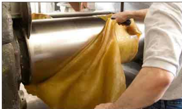
Obrázek č. 1: Válcování pryže na dvouválci {1}
