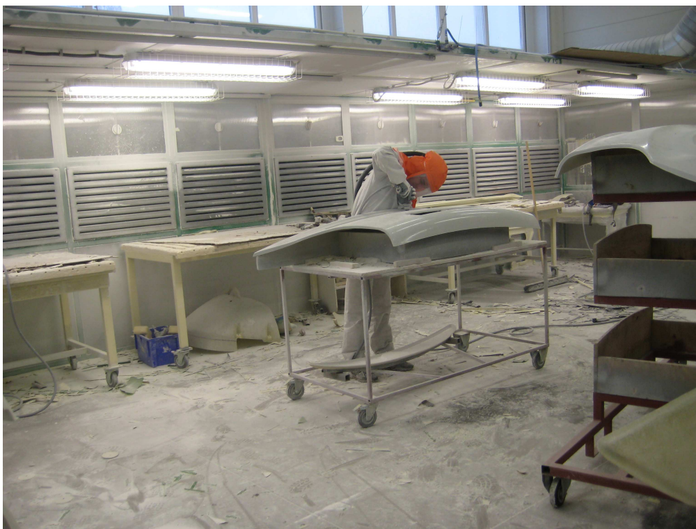
Obrázek 13 – pracoviště ořezu s bočním odsáváním prachu (při ořezu laminátu stojí pracovník čelem k odtahům)
