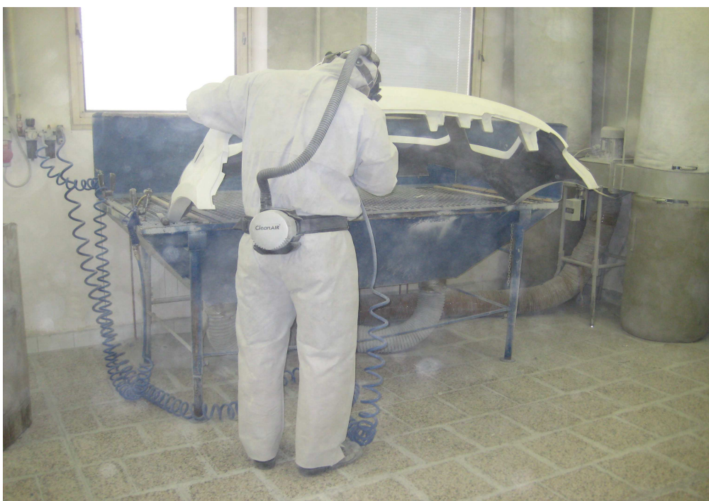
Obrázek 14 – ořez laminátových dílů se spodním odtahem prachu
