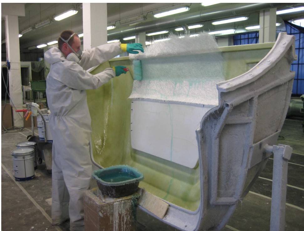
Obrázek 6 – ruční laminace (prosyčování skelné tkaniny pryskyřicí)
