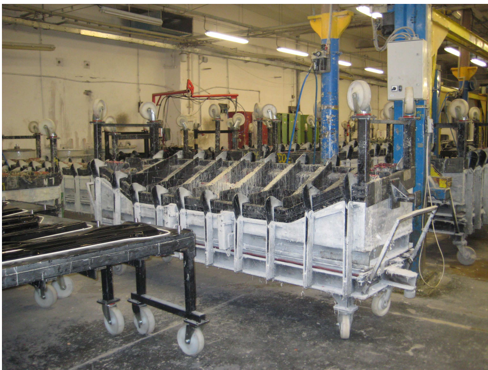
Obrázek 12 – RTM-strojní laminace: pracoviště s injektážním zařízením
