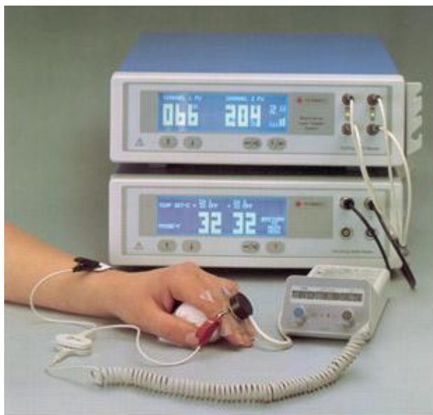
Obrázek 10. Přístroj a ukázka vyšetření metodou laser-Doppler (převzato z firemních materiálů www.perimed-instruments.com ).
