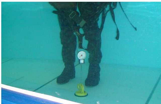
Obrázek č. 12: Měření vztlaku batohu pomocí vakuové přísavky a ruční váhy, foto: archiv
