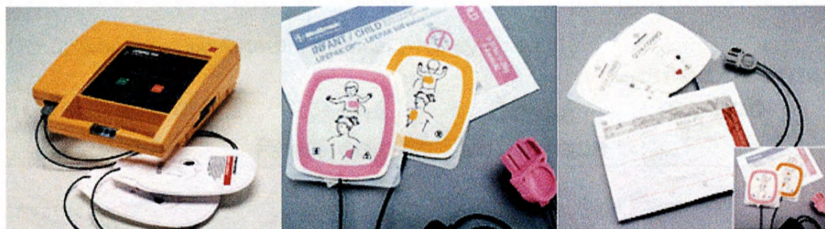
Obr.4: AED s možností napojení dětských nebo dospělých samolepících elektrod [4]
