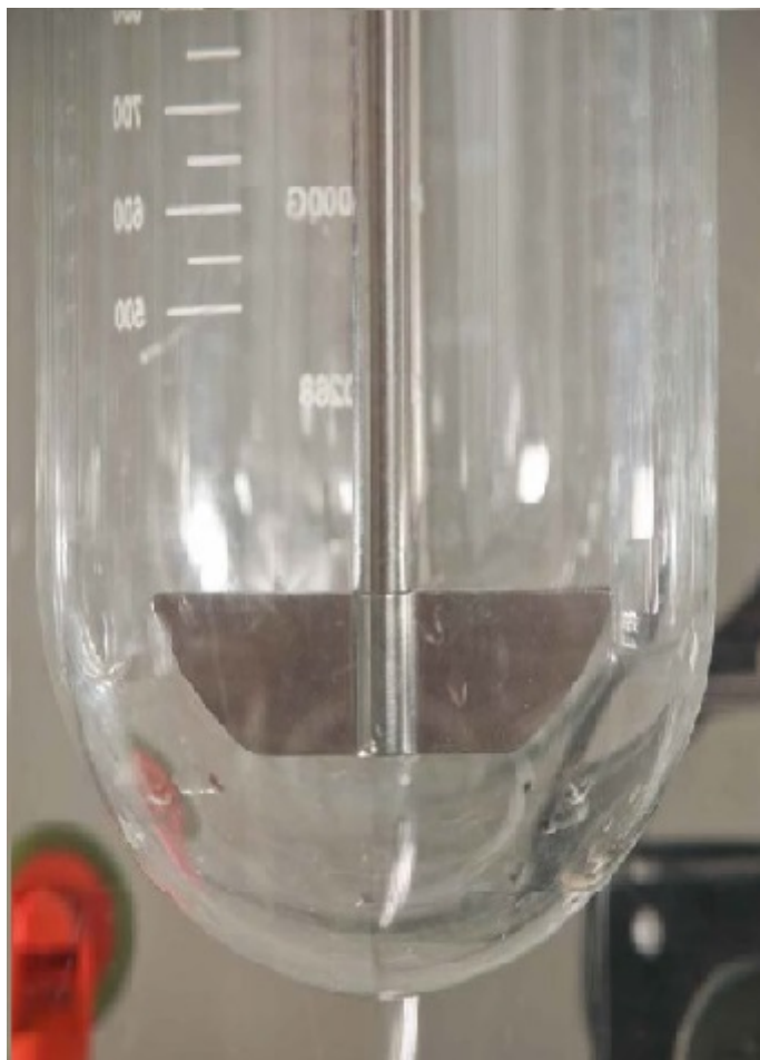
Obrázek 8: Pohled na míchadlo, převzato z [17]
