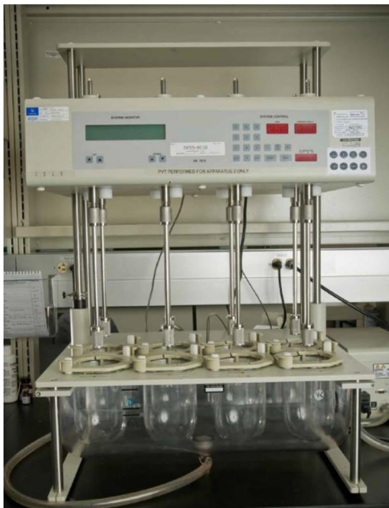
Obrázek 5: Přístroj pro košíčkovou metodu, převzato z [17]
