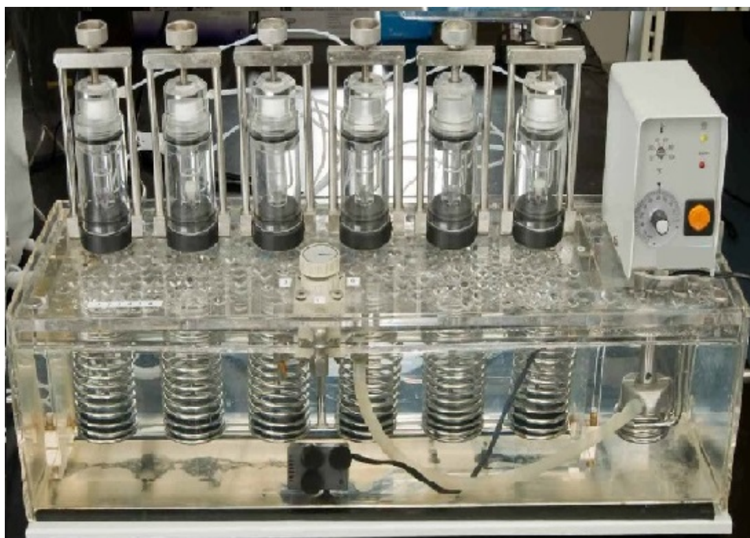
Obrázek 11: Příklad přístroje s průtokovou celou, převzato z [17]
