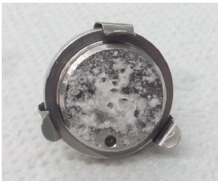
Obrázek 23: Tvorba pěny při disolučním testu tablet lisovaných ze směsi B5
