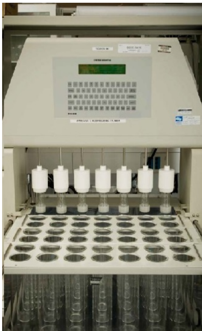
Obrázek 9: Aparát s vratným válcem, převzato z [17]
