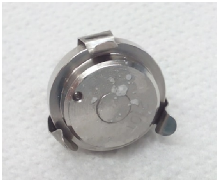
Obrázek 22: Tvorba pěny při disolučním testu tablet lisovaných ze směsi B2
