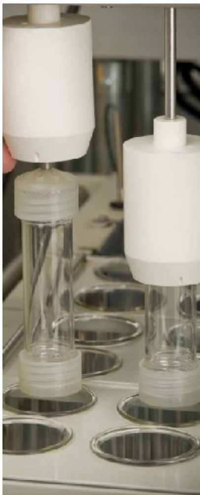
Obrázek 10: Pohled na vratný válec, převzato z [17]
