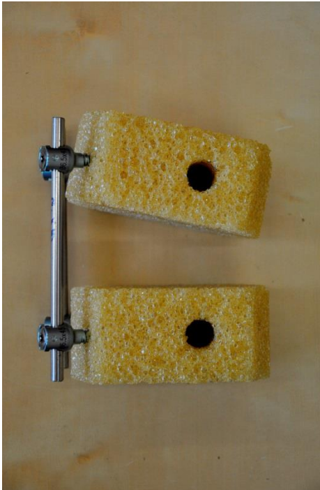
Obrázek 7. Selhání soustavy uvolněním transpedikulárního šroubu z PUR bloku tzv. „windshield wiper“ efekt.
