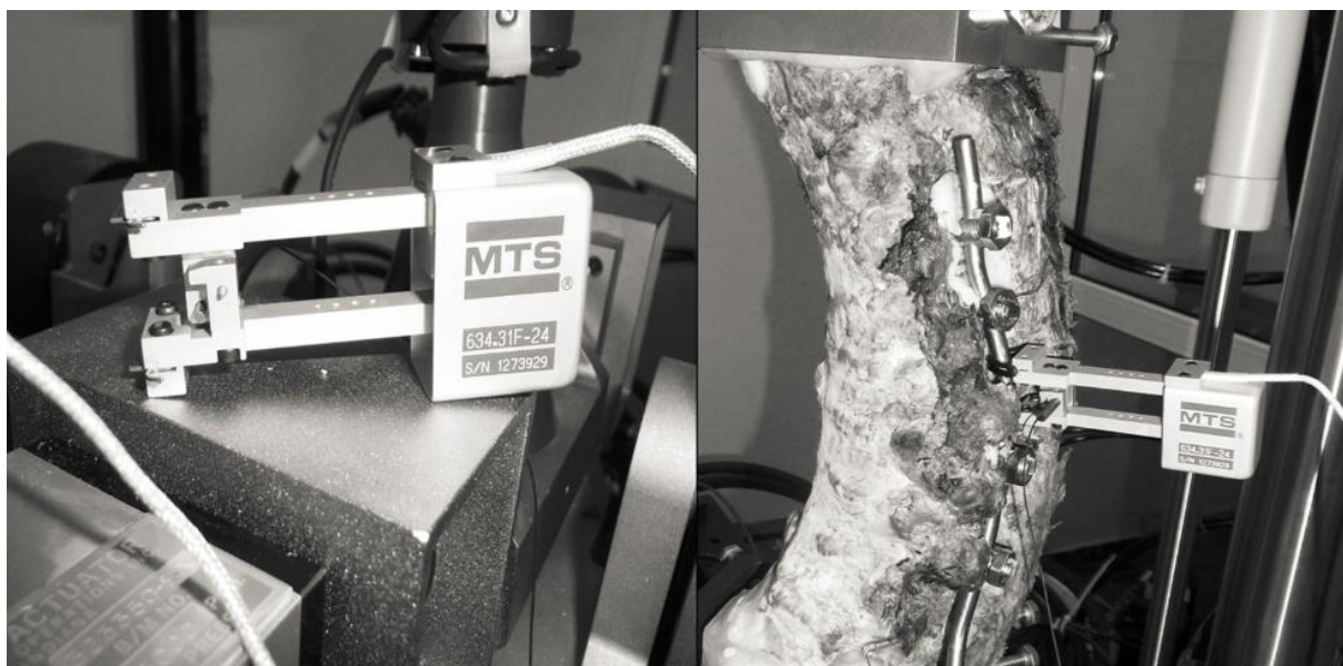
Obrázek 4. Extenzometr MTS s pracovním rozsahem 1/- 0,4mm
