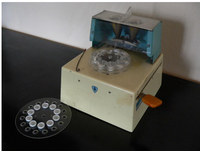
Obrázek 14. Automatický dělič prášků vyvinutý RLS (archiv ČFM).
