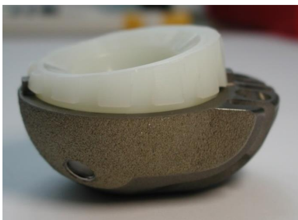
Obr.12 Převis polyethylenové vložky přes okraj TC jamky.
