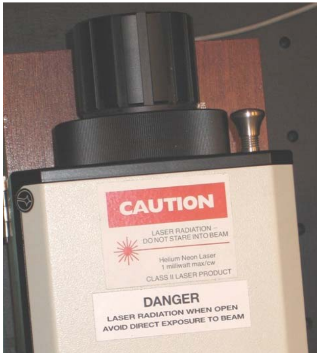
Obr. 16 Měřící hlavice laserového dopplerovského vibrometru (LDV), kterým se bezkontaktně snímá pohyb zatěžovacího rámu při nárazu padajícího závaží
