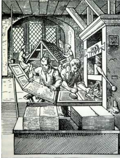
Obrázek 3 Tiskárna z počátku knihtisku s tiskovým lisem se svislým vřetenem, ruční navalování barvy balíky. V pozadí sazeč při sazbě z písmovky.
