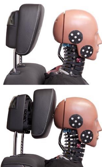
Obrázek 6: Aktivní opěrka hlavy na principu servomotorů (Sajdl, 2011; dostupné z: http://cs.autolexicon.net/articles/hyperextenze-krku-whiplash/ )
