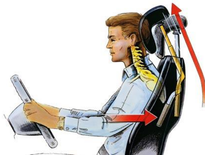
Obrázek 5: Princip pákového mechanismu aktivní opěrky hlavy (Sajdl, 2011; dostupné z: http://cs.autolexicon.net/articles/hyperextenze-krku-whiplash/ )
