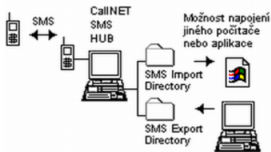
Ilustrace 3: Schéma fungování aplikace CallNet Message Hub
