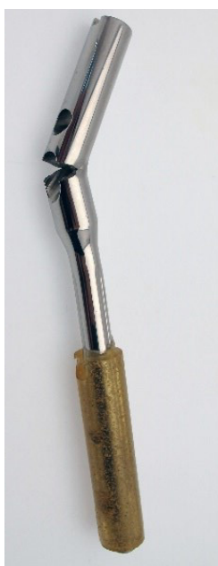
Obr. 37. Zlomený krátký rekonstrukční hřeb během cyklických zkoušek (snímek použit se svolením firmy Medin a.s.).
