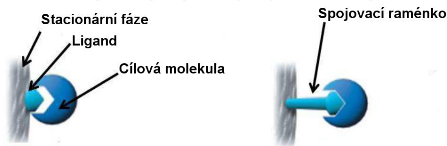
Obr. 6: Vliv délky spojovacího raménka na schopnost zachytit cílové molekuly. V případě nedostatečné vzdálenosti mezi ligandem a stacionární fází může docházet ke sterickému bránění interakce s cílovou molekulou (upraveno dle Magdeldin and Moser, 1996).
