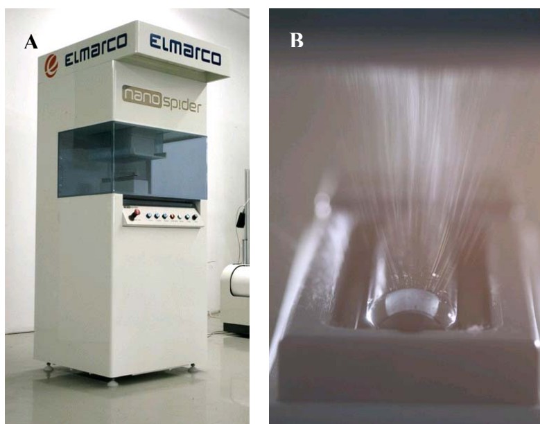
Obr. 3.2 Technologie Nanospider™. A. Přístroj Nanospider určený pro laboratorní použití, B. Taylorovy kužele vznikající na válci ponořeném v roztoku polymeru.
