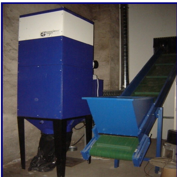
Obr. 52: Odsávání a filtrace prachu [143]
