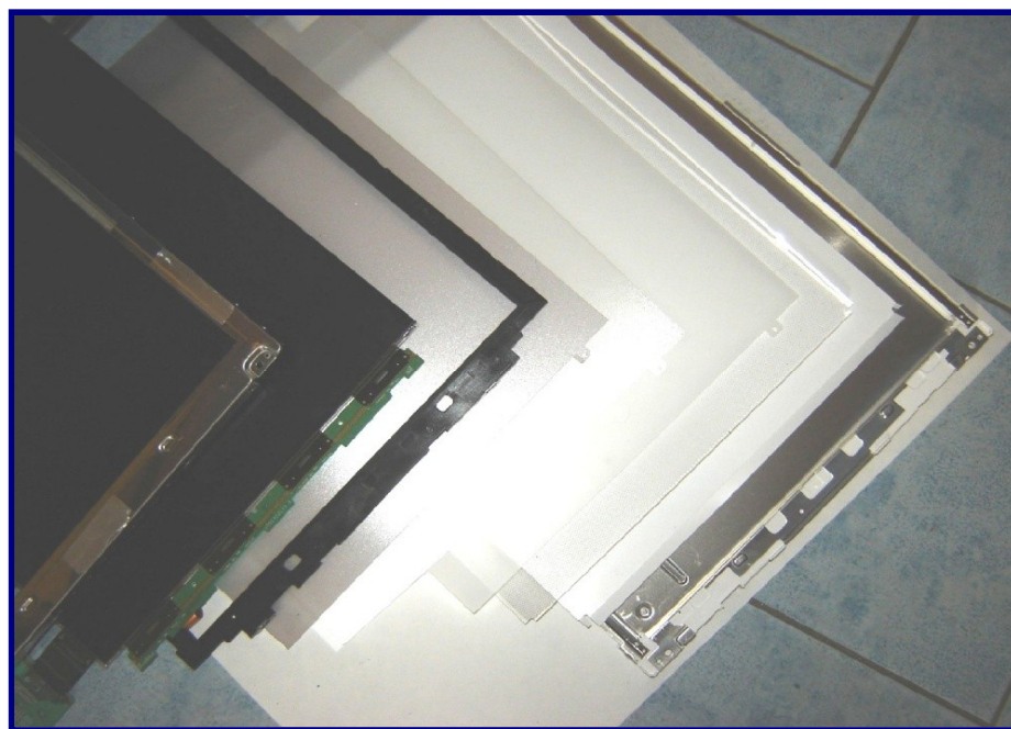
Obr. 66: Řazení jednotlivých vrstev obrazovky [143]
