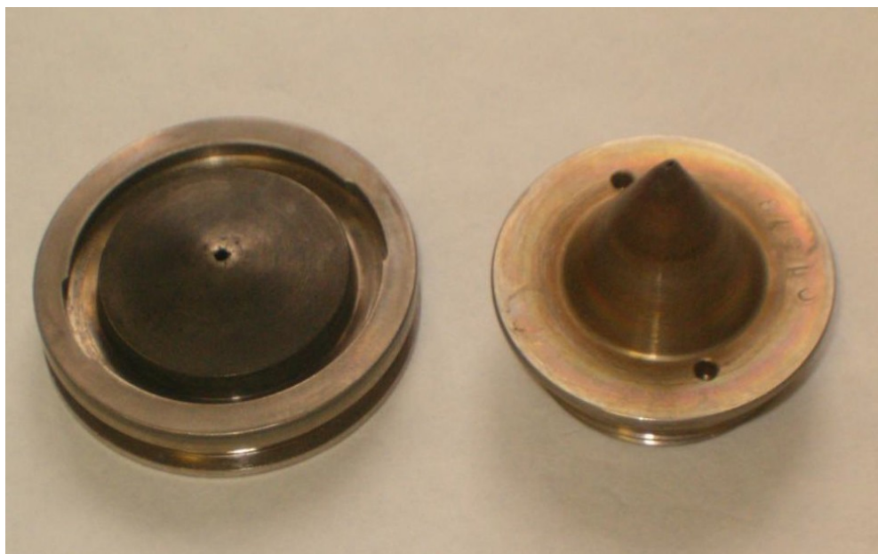
Obr. 42: Konusy pro odbět iontu [94]
