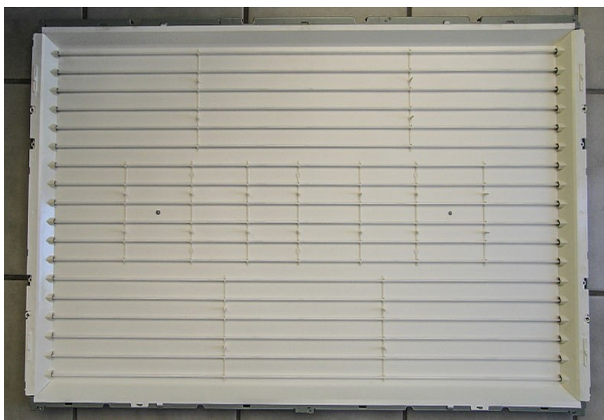
Obr. 5: Podsvícení 42" LCD TV 18 paralelními CCFL trubicemi [2]
