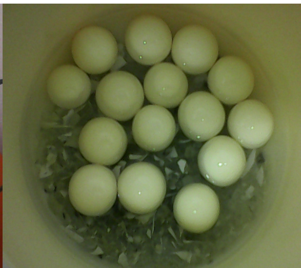
Obr. 71: Vzorek skla v přebytku ethanolu před mletím
