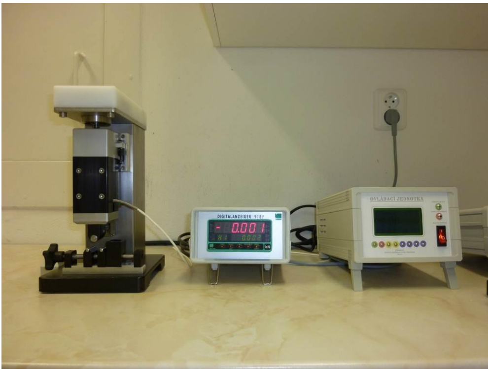
Obrázek 8: “Na zakázku“ vyrobený přístroj pro testování mechanických vlastností kostí třibodovým ohýbáním a odolnosti v tlaku.
