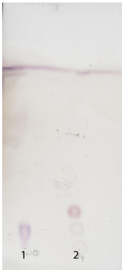
Chromatogram č.3: 1:K2, 2:směs s obsahem stigmasterolu, mobilní fáze \text{CH}_2\text{Cl}_2
