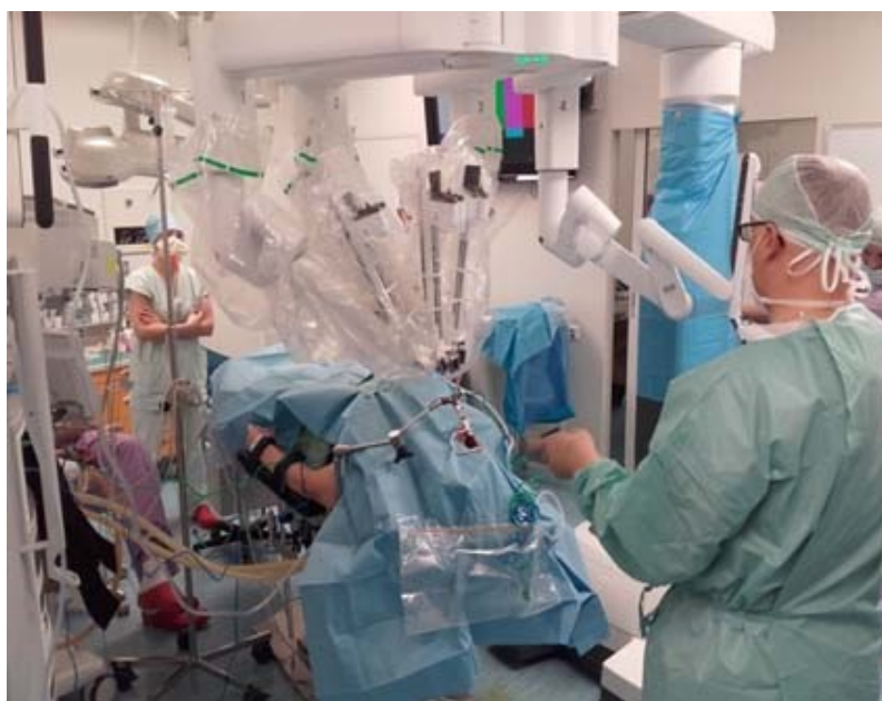
Obr. 9 - Otočná platforma systému daVinci Xi, fáze dokování
