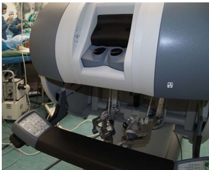
Obr. 7 - Detail konzole daVinci S-HD s okuláry a ovládacími pákami
