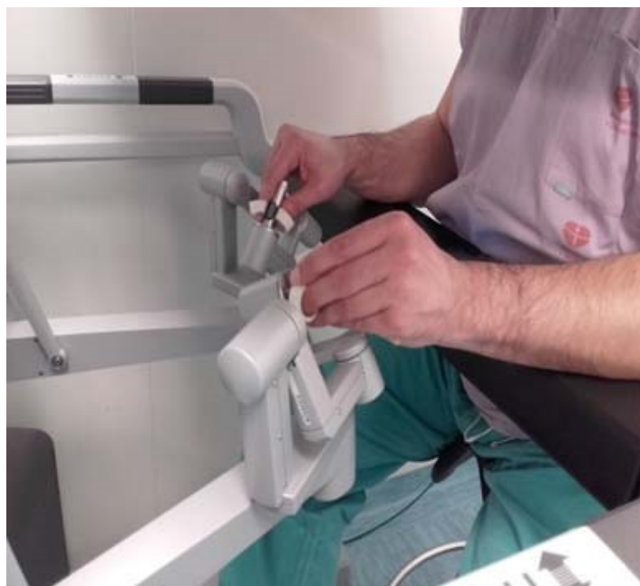
Obr. 16 - Ovládací páky konzole s objímkami prstů
