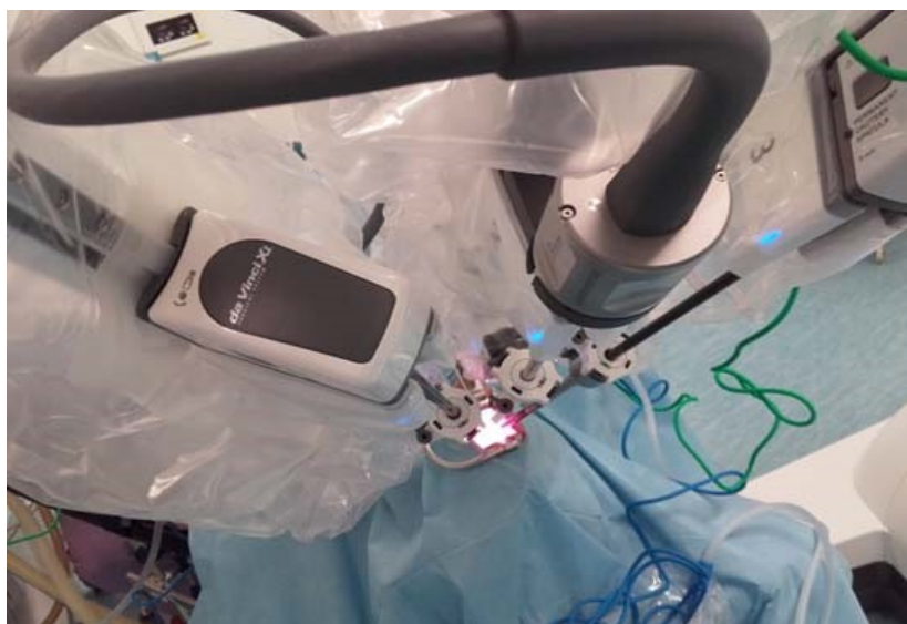
Obr. 14 - Uprostřed umístěná 8mm HD kamera systému daVinci Xi
