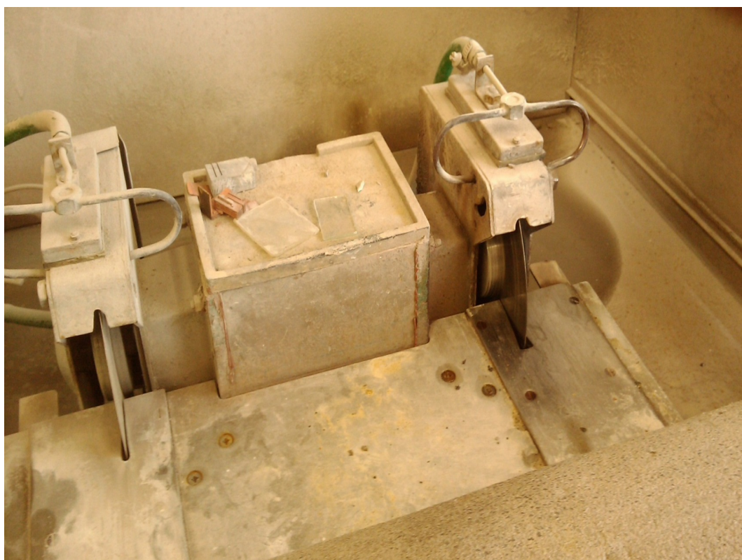
Obrázek č. 3 – Snímek diamantové pily – zdroj: Ing. Zdeněk Jandák, CSc. fotografie pořízena během měření vibrací ve sledované kauze v roce 2012
