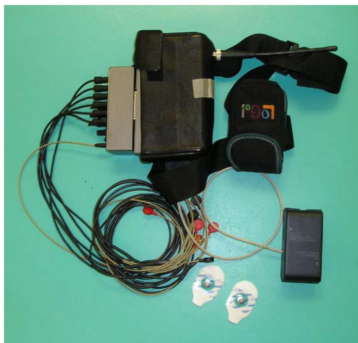
Obr. 6 VYSÍLAČ S TELEMETRICKÝM PŘENOSEM SIGNÁLU SPOLEČNĚ S POVRCHOVÝMI ELEKTRODAMI A S PŘÍVODNÍMI KABELY (fotoarchiv autora)
