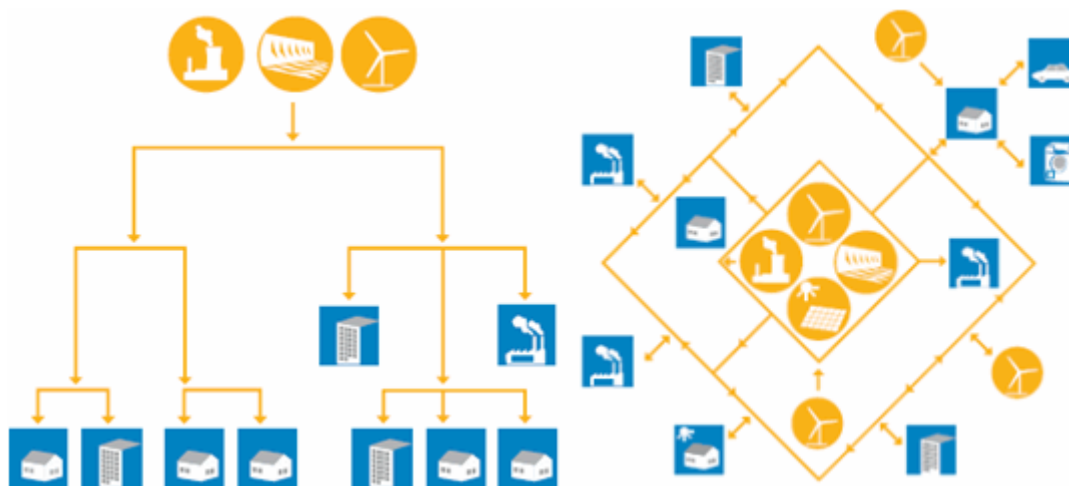
Schéma 2 - Schéma klasické a chytré sítě
