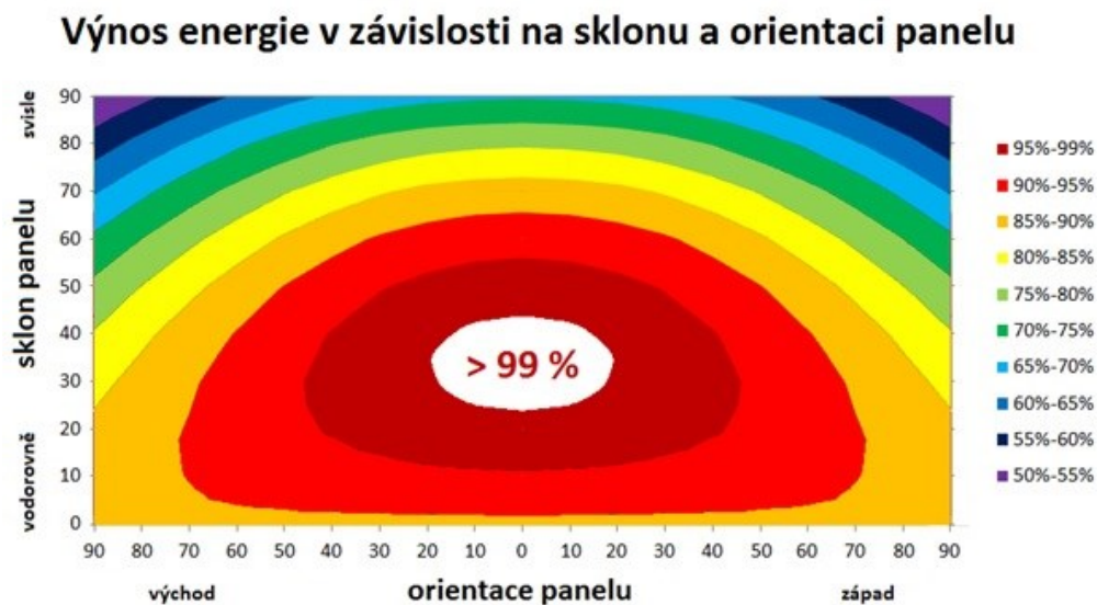
Graf 7 - Výnos energie v závislosti na sklonu a orientaci panelu ( kWh/m^2 )
