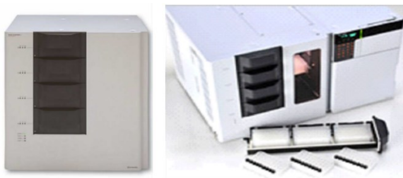
Obrázek 5: Autosampler pro mikrotitrační destičky (převzato ze zdroje Shimadzu [17]).
