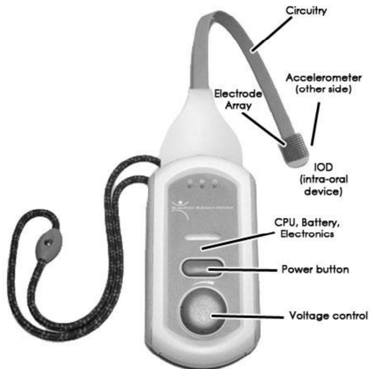
Obr. 1: Přístroj BrainPort® (Wicab, Inc.) Circuitry = obvody; Electrode Array = elektrodové pole; Accelerometer = akcelerometr; IOD (intra-oral device) = intraorální jednotka; CPU (central processing unit) = řídicí jednotka.
