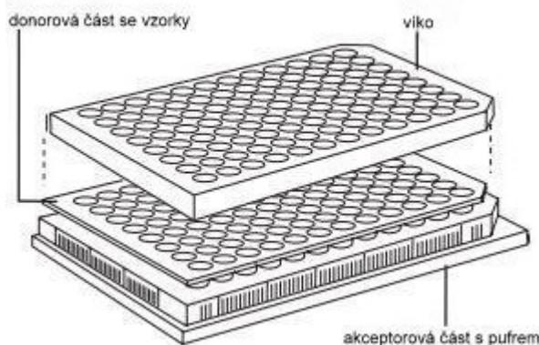
Obr. 14: „Sendvičové“ uskupení mikrotitračních desek. Spodní akceptorová část obsahuje pufr, v našem případě PBS či F-127. V prostřední donorové části jsou napipetovány vzorky standardů či testovaných M2 látek. Modifikováno dle: (Oxendine et al., 2006)
