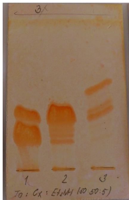
Obrázek 17: Chromatogram F6/1, F6/2, F6/3. Mobilní fáze S2, nosič A2. Vizualizováno Dragendorfovým činidlem.
