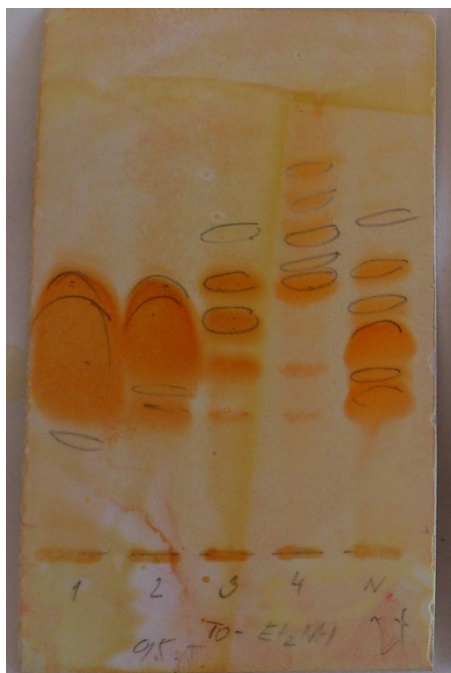
Obrázek 16: Chromatogram F6/1, F6/2, F6/3, F6/4 a F6. Mobilní fáze S1, nosič A2. Vizualizováno Dragendorfovým
