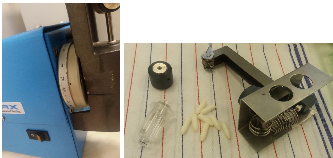
Obrázok 28 a 29 Detail na stupnicu čerpadla (vľavo), pohľad na disolučný prístroj s čapíkmi (vpravo)
