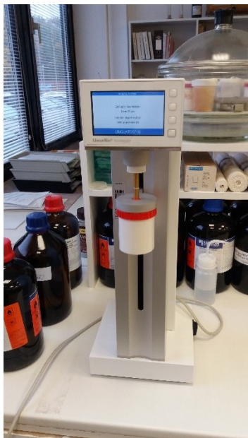
Obrázok 26 a 27 Prístroj Unguator Q pri homogenizácii (vľavo) a jeho komponenty – téglík, veko, miešadlo a aplikačný nastavec (vpravo)
