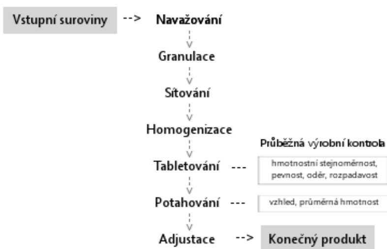
Obr. 29: Schéma výroby jader přípravku Spofavit ®
